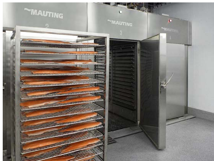
Obr. 3: Pro výrobky v horizontální poloze je vhodné zařízení UKMH 2001.E.
