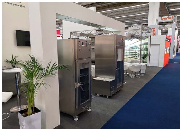
Obr. 7: Mikroklimakomora KMU MINI umožňuje výrobu běžných typů trvanlivých masných výrobků, mēlněných i celosvalových.
